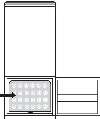
Mit der Zeit bildet sich an den Wänden des Gefrierteils eine Eis- bzw. Reifchicht. Dies führt zu einem höherem Energieverbrauch Ihres Kühlschranks. Um dies zu vermeiden, muß diese Eisschicht mindestens 2 Mal im Jahr entfernt werden.
