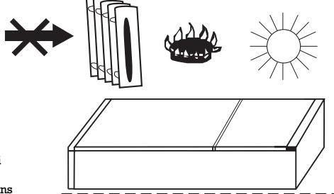
Si vous avez besoin de couper le réfrigérateur pour le déballer ou pour changer de côté ses gonds de pivotement de ses portes, LE REFRIGERATEUR NE PEUT ETRE COUCHE QUE SUR SA PARTIE POSTERIEURE.
