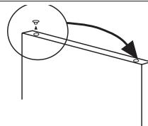
Introduca la cerniera intermedia nell'asse sinistro della porta inferiore e la avviti al frigorifero, staccando previamente il protettore dei fori.
