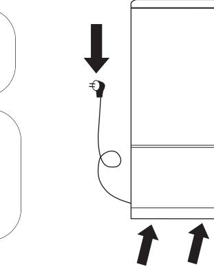
Regulando los pies de nivelación comprobar que el frigorífico queda bien apoyado en el suelo (sin cojear) y bien nivelado (no ladeado).
