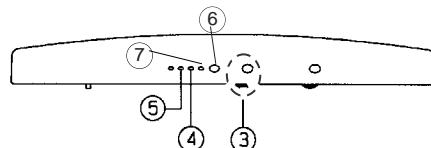
En tournant le thermostat ③ dans le sens des aiguilles d'une montre, le voyant ④ s'allumera et le congélateur se mettra en route. L'alarme ⑤ s'allumera aussi puisque le congélateur ne sera pas encore froid.
