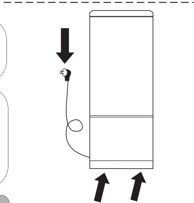
Ce réfrigérateur fonctionne à 220/230v. Si vous disposez d'une tension différente dans votre foyer, vous devrez utiliser un transformateur d'une puissance non inférieure à 500 w. Utilisez une prise de courant avec MISE A TERRE.
