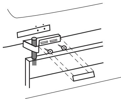
Introduca la cerniera nella sua sede della parte sinistra del pannello dei comandi e nell'asse della porta superiore simultaneamente. Sostenga la cerniera con la vite laterale.
