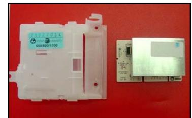
**Nota:** el contacto 4 del modulo puenteadando con el 5 y el 3 el motor funciona en centrifugado en rampa sin realizar el puente funciona en lavado
