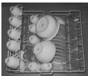
Conforme à EN-50242
