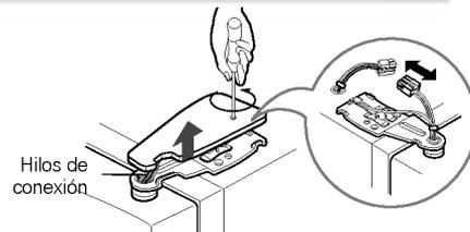
2) Suelte la protección girando en sentido horario (⌚) y suelte la bisagra superior elevándola (⌚).
