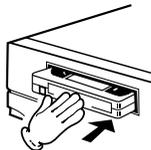
Inserte la cinta con el lado de la etiqueta hacia arriba y la pestaña de protección contra el borrado accidental hacia la izquierda. La cinta al revés no se puede insertar.
