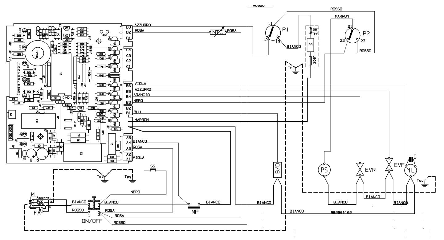
MP = Microporta FA = Filtro antidisturbo a 1mm TS = Termostato di sicurezza № 0.75mm P1 = Pressostato di livello P2 = Pressostato di sicurezza ® 0.5mm AQS = Dispositivo acquastop SS = sensore sale SB = Sensore brillantante NTC = Sensore temperatura RR = Resistenza riscaldamento B/D = Dosatore brillantante / detersivo EVR = Elettrovalvola di rigenerazione EVF = Elettrovalvola di carico ML = Motore lavaggio
